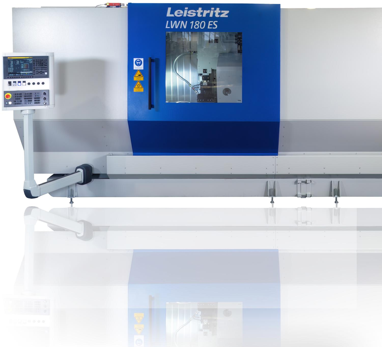
Die Rotorschälmaschine LWN 180 ES wird für die Außenbearbeitung von Exzentrerschnecken bis 1.000 mm Länge verwendet und steigert die Produktivität und Oberflächengüte gegenüber herkömmlichen Anlagen um 65 %.
