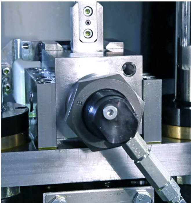
Bild 1: Hydraulisches Spannsystem für die Messerstange
