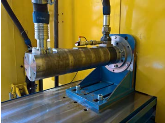
Beispiel einer L3U-Schaubenspindelpumpe
